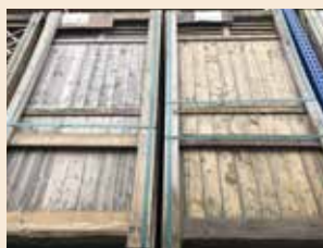
Färgskiftningar för gråimpregnering
