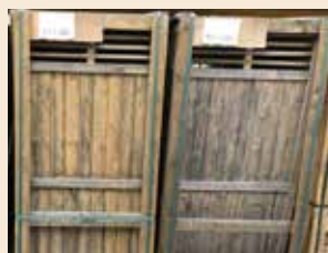
Färgskiftningar för gråimpregnering
